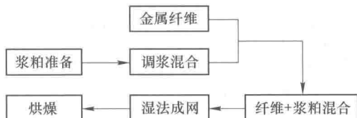
图 1-2 制备金属纤维毛毡的湿法工艺流程
