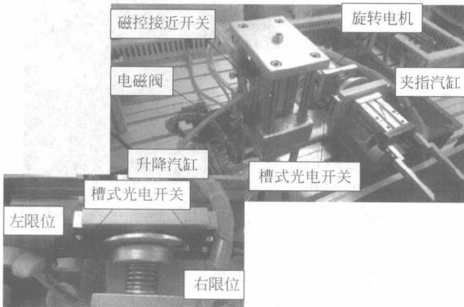
图 1-9 翻转机械手机构
