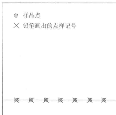
图 1-2 层析滤纸上氨基酸点样示意图
