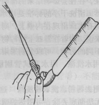
图 1-1-6 碱式滴定管排气泡的方法
