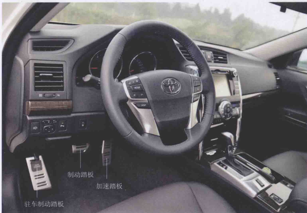
自动挡汽车手柄旁的挡位指示
