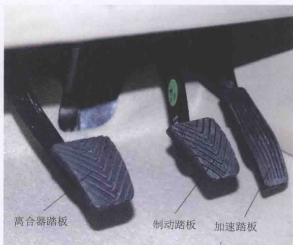
手动挡汽车驾驶室内踏板
