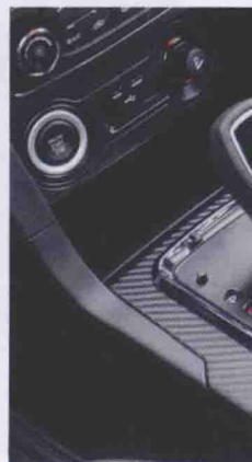
自动挡汽车手柄旁的挡位指示
