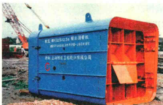
图 1.2-4 国内自主研发的可变网格矩形盾构机
