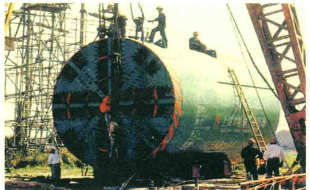
图 1.2-2 直径 5.17m 加泥式土压平衡盾构机
