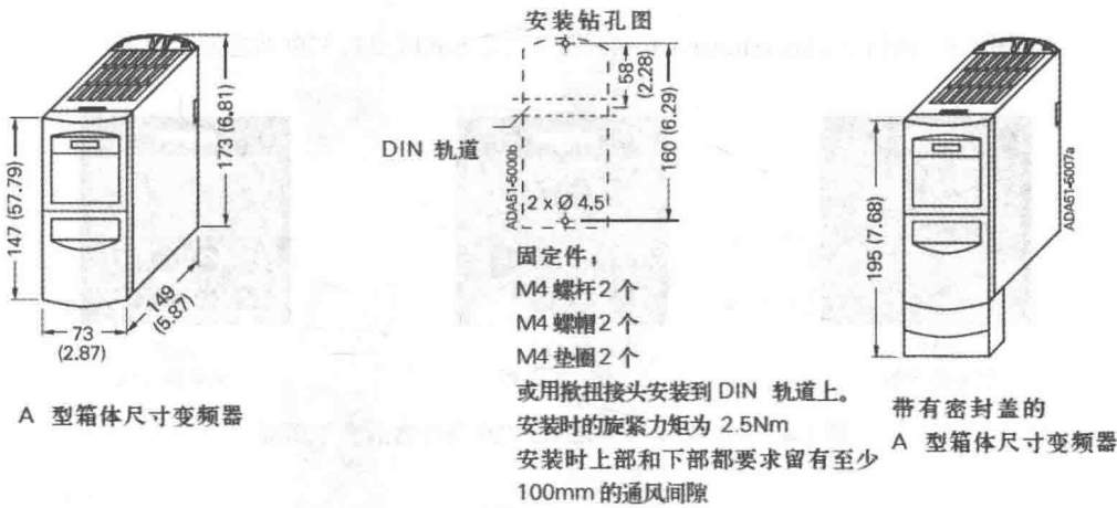
图 1-2 西门子 MicroMaster 420 变频器安装尺寸图（A 型）
