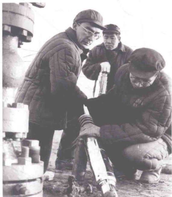
王德民（左）与徐文卓（右）在现场进行偏心配产配注工艺试验（摄于1973年）
