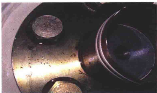
图 1 定位销放电击穿痕迹
