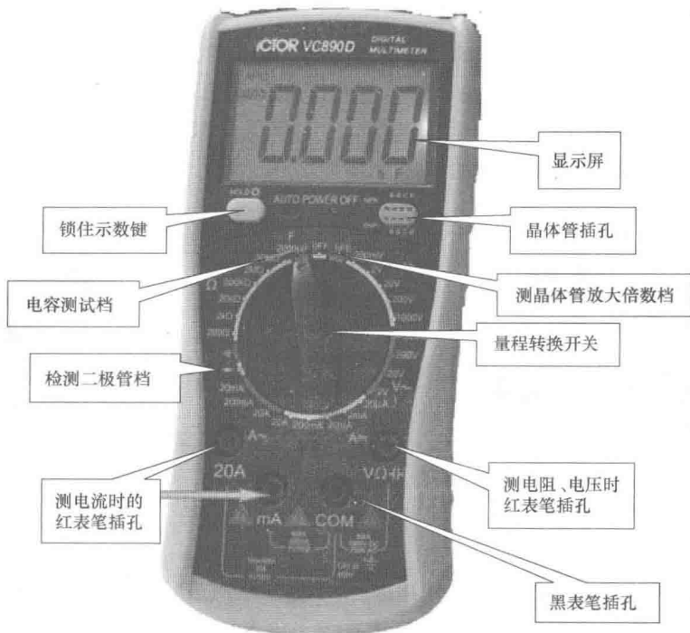
图 1-18 数字式万用表的结构
