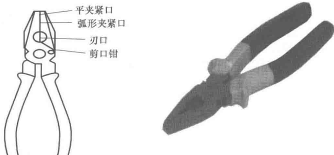
图 1-12 钢丝钳的结构图和实物图
