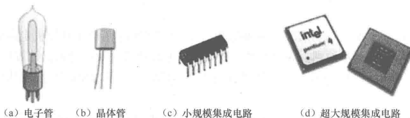
图 1-4 计算机中采用的物理元器件
