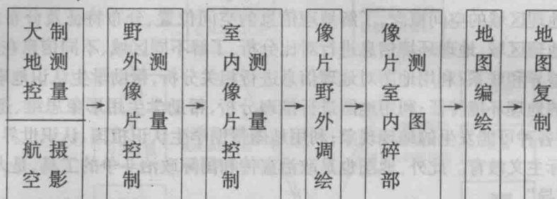
图 1—4 航空摄影测量成图过程
