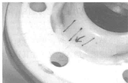
图 1-4 接地绝缘子瓷套裂纹
