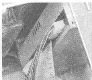
图 1-30 安装光驱的数据线和电源线
