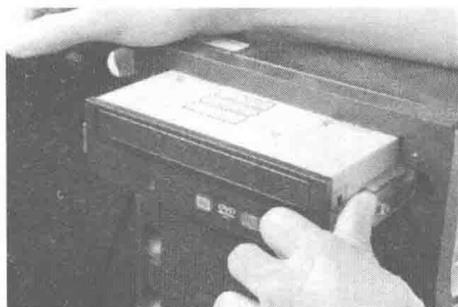
图 1-24 安装光驱到机箱
