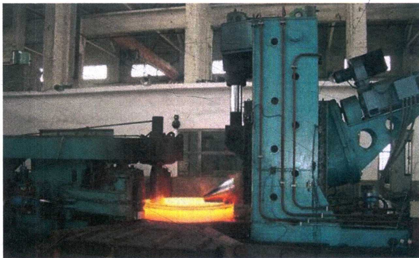
图 1.1 环形件径轴向轧制过程
