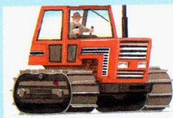
与使用大轮胎的拖拉机相比，履带式拖拉机能够在石头很多的地方或者十分光滑的地面上行驶。
