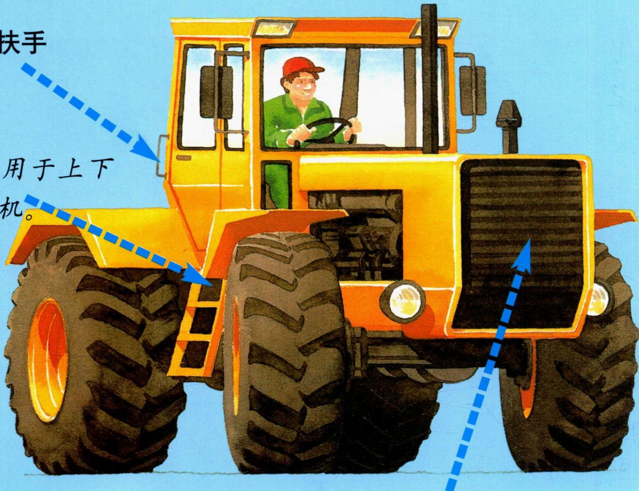
它有4个大小相同的巨大轮胎。为了获得最大的抓地力，它采用四轮驱动：发动机同时驱动4个轮子，而不是2个。
