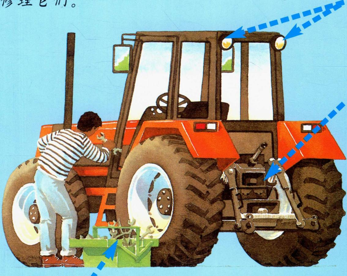
工具箱里面装有各种修拖拉机的工具，包括扳手、钳子、螺丝刀，当然还有锤子。一些检测电路的工具也装在里面。此外，机械师还带着替换部件。
