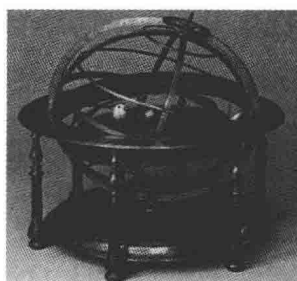
图 1.6 水运浑象仪，可以自动地与地球运转同步
