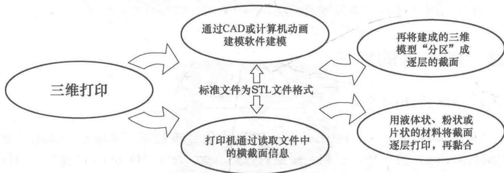
图 1-4 3D 打印的基本原理
