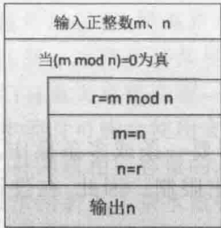
图 1-2 求解两个正整数的最大公约数的流程图
