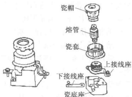
图 1.1.13 RL1 系列螺旋式熔断器
