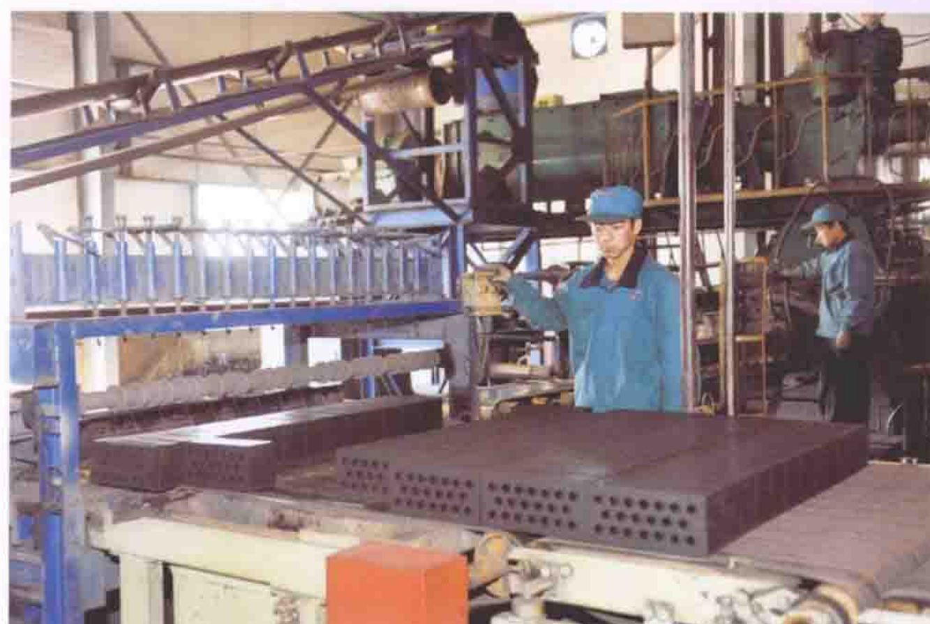
多孔砖成型压制工序
