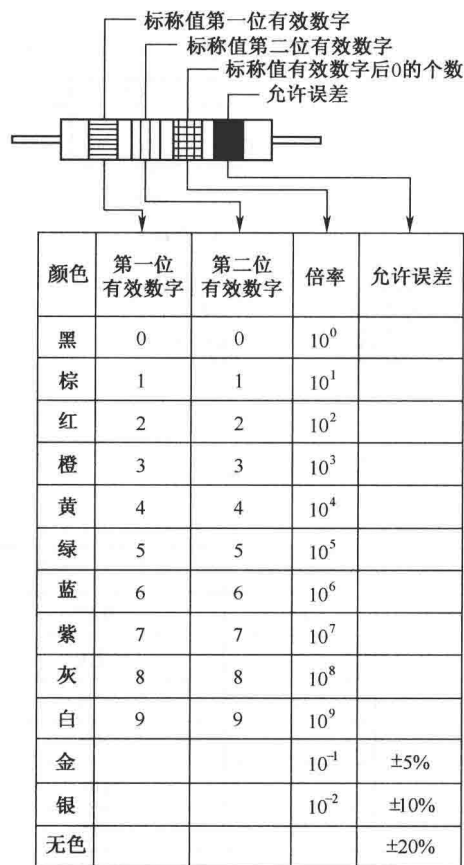
图 1-6 2 位有效数字的阻值色标表示法
