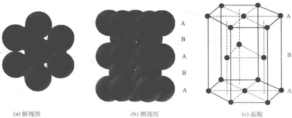
图 1-5 密排六方结构示意图
