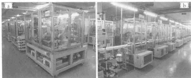
图3 配线用断路器的组装生产线
