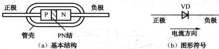
图 1.3 二极管的基本结构和图形符号
