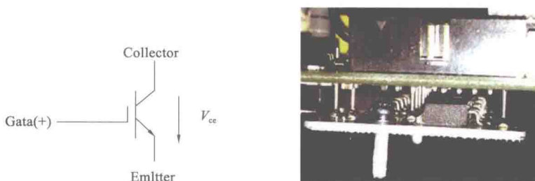
图 1-5 IGBT 电气符号图和实物图
