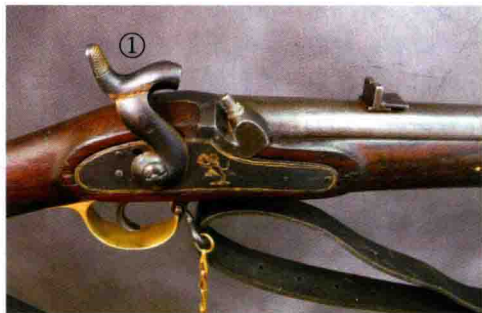
①点火装置为击发枪机撞击火帽，射速大约为每分钟3~4发
