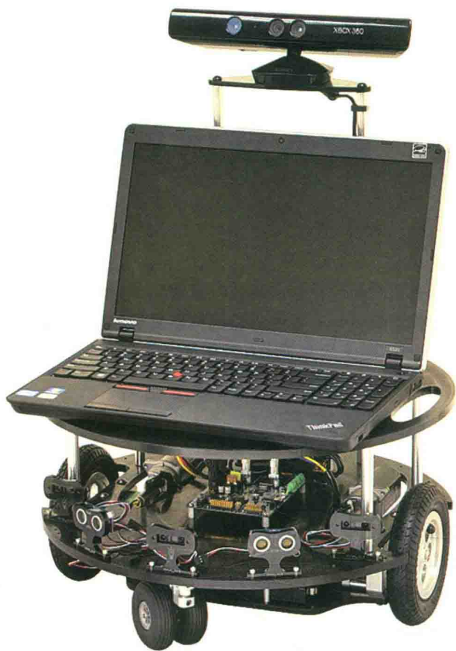
图1.1 Parallax公司生产的机器人平台(已退役): 其嵌入式系统中包含了一台笔记本电脑
