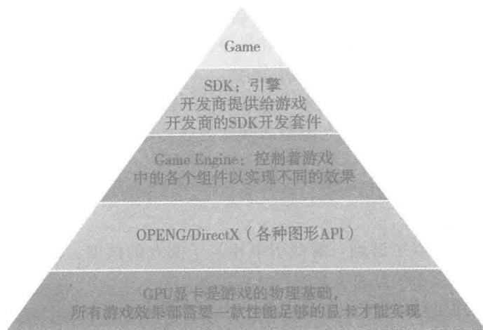
图 2-1 游戏引擎与 GPU 的关系图
