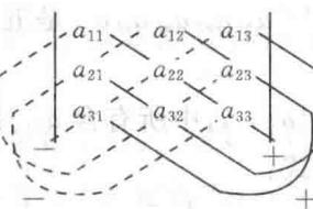
其中各实线连接的三个元素在主对角线上或在与主对角线平行的实线上,其乘积都是式(1.1.1)右端中带正号的项,各虚线连接的三个元素在次对角线上或在与次对角线平行的虚线上,其乘积都是式(1.1.1)右端中带负号的项.
