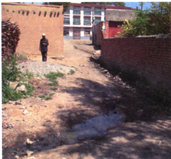
村镇由于没有污水收集管道，污水直接排放，污染周边环境
