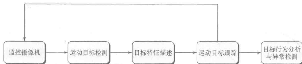
图 1-4 智能视频监控系统的结构框架
