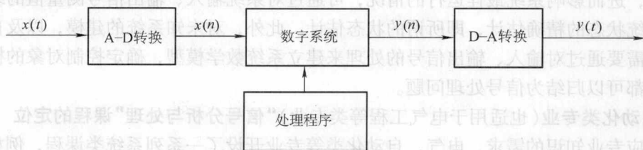
图 0-3 数字信号处理系统框图
