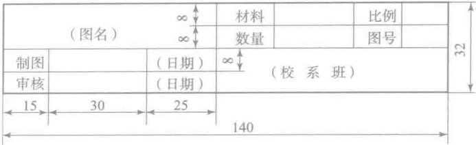
图 1-4 简化的零件图标题栏
