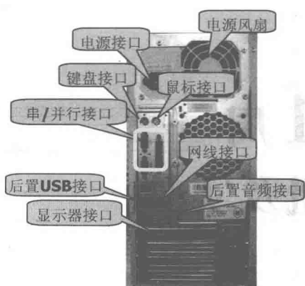
图 1-2 主机后面板组成
