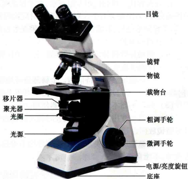
图 1-1 双筒显微镜示意图
