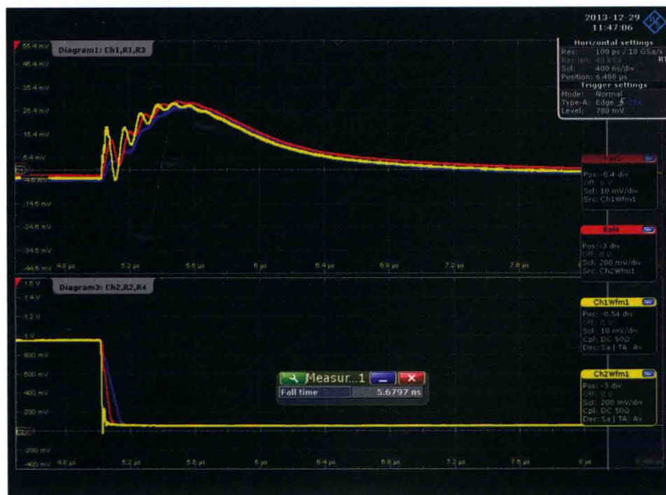
图 11.16 通过一个 SMA T 型转接头将 Picotest J2112A 和 LDO 演示板相连。负载的峰值大约为 1A，上升时间分别为 5.7 ns（黄色）、50ns（红色）和 100ns（蓝色）
