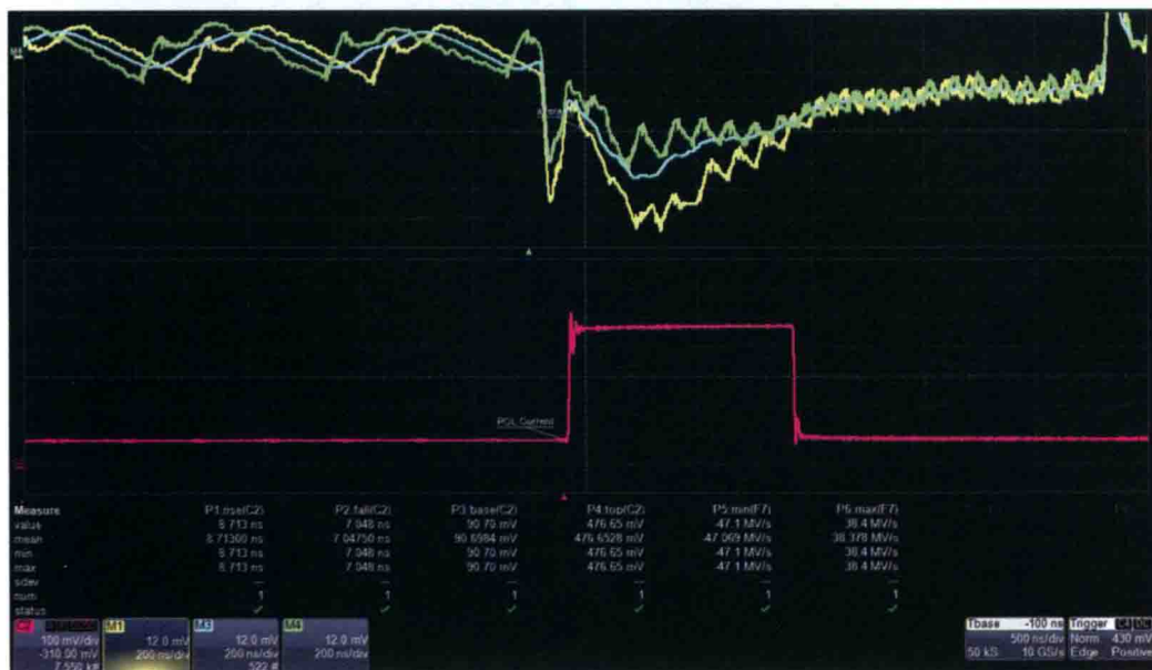
图 11.8 两个不同的采集数据如图上绿色和黄色波形，蓝色波形是轨迹平均值的结果，电流阶跃是粉色波形
