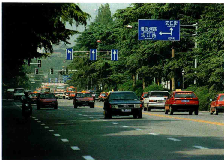
与路口长臂杆多相位信号灯配套的大型指路牌、车道牌,为行车提供了保证。图为:南京市北京东路上的大型指路牌、车道牌和安仁街路口的长臂多相位信号灯。
