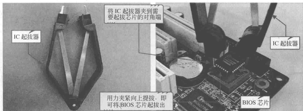
图 1-3 IC 起拔器及其使用场合
