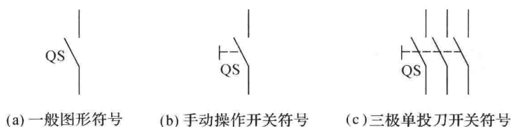
图 1-2 HD 型单投刀开关图形符号
