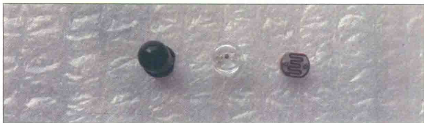
图1-9 3种常见的感光器件，从左往右依次为：5mm红外线接收管、5mm光敏二极管、光敏电阻
