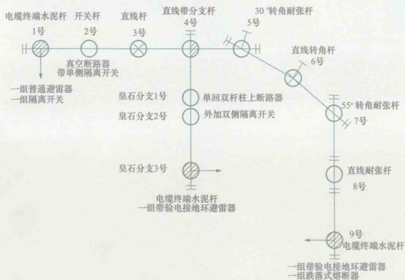
图 1-1 10kV 龙湖环线典型设计路径图
