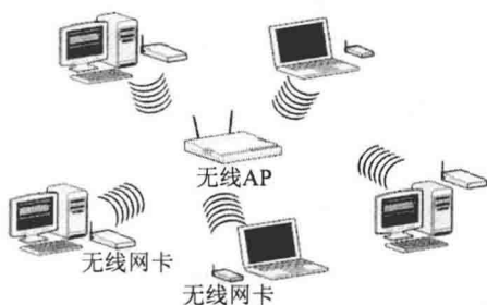
图 1-4 基于 AP 的基础架构结构
