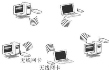
图 1-3 点对点 Ad-Hoc 结构
