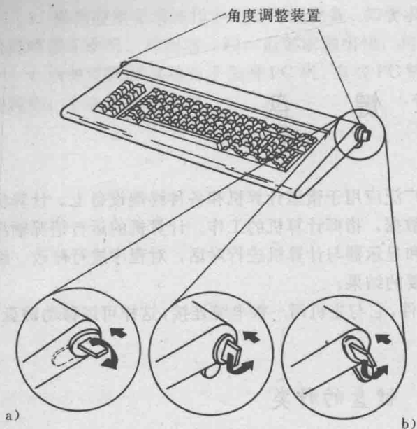
图 2-1 PC 机用的 83 键键盘角度调整装置
