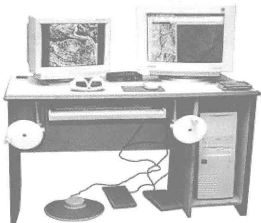
图 1-6 VirtuoZo 数字摄影测量工作站
