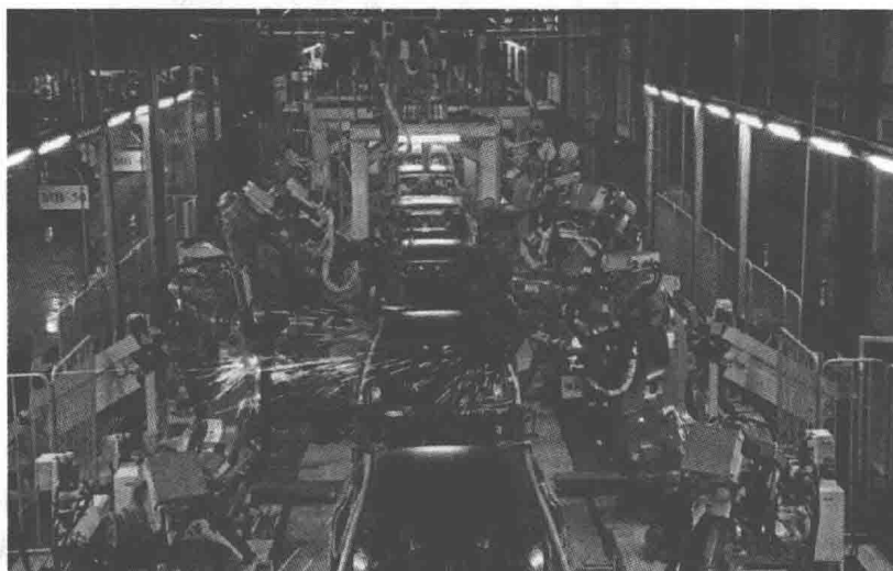
图 1-4 汽车装配线上的焊接机器人
