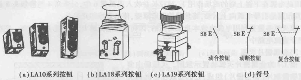
图 1.8 控制按钮的结构示意图及符号
