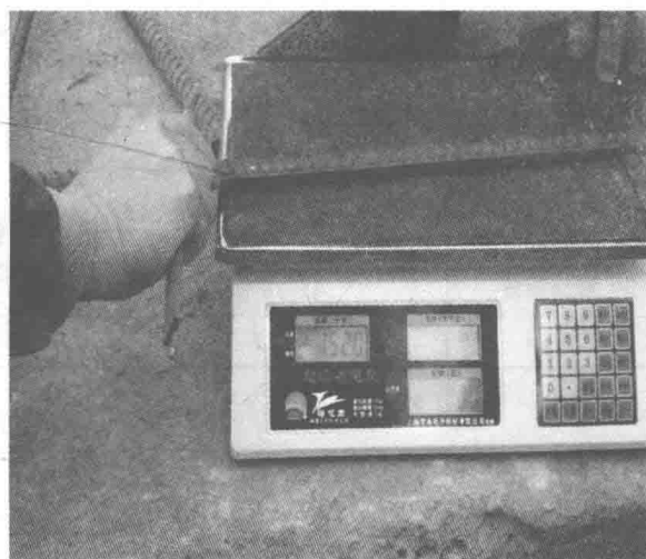
图 1-23 电子秤计量钢筋实际重量
