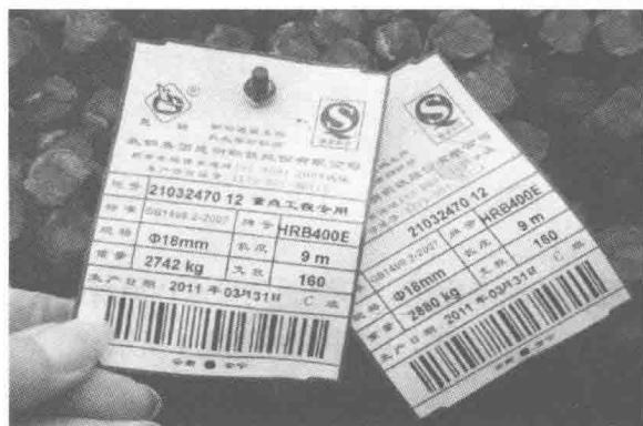
图 1-5 合格钢筋铭牌正确悬挂
