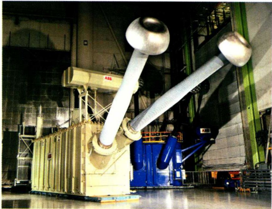
图 1-9 向上工程奉贤换流站 800kV 换流变压器
