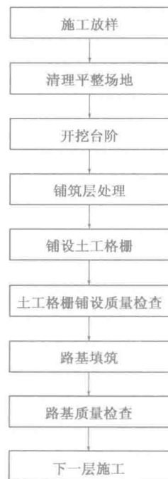
图2 三向土工格栅施工工艺流程图
